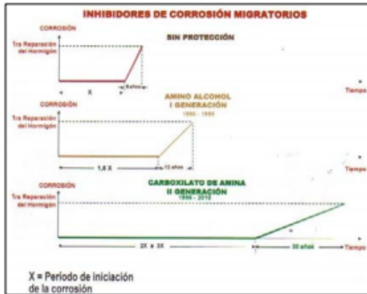
Figura 3.5: Periodo de iniciación de corrosión sin protección y con inhibidores de corrosión
